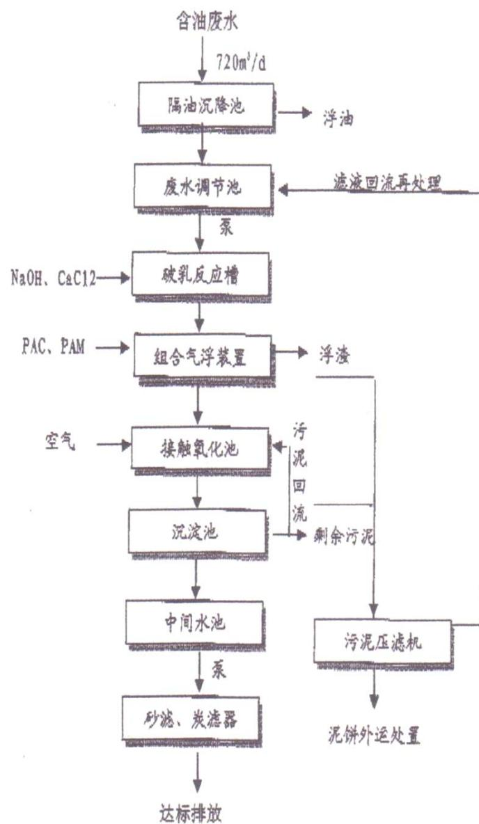
(图表 2 - 污油水处理工艺流程图)
